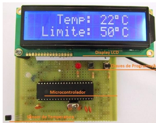
Figura 4 – Protótipo da placa com seus componentes (Fonte: do autor, 2016)
