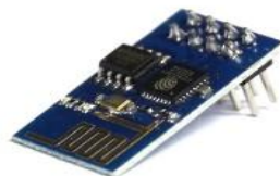
Figura 2 – Módulo wireless ESP8266 Modelo ESP-01 – Fonte: EMBARCADOS, 2016
