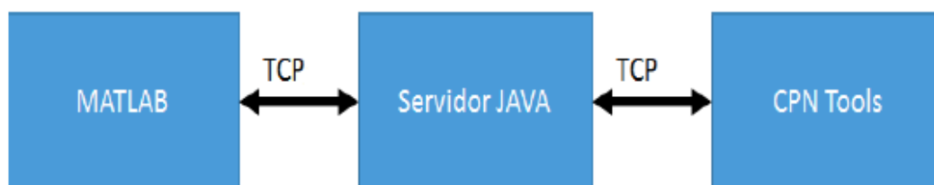
Figura 2: Diagrama representando a interligação entre softwares utilizados na pesquisa.
